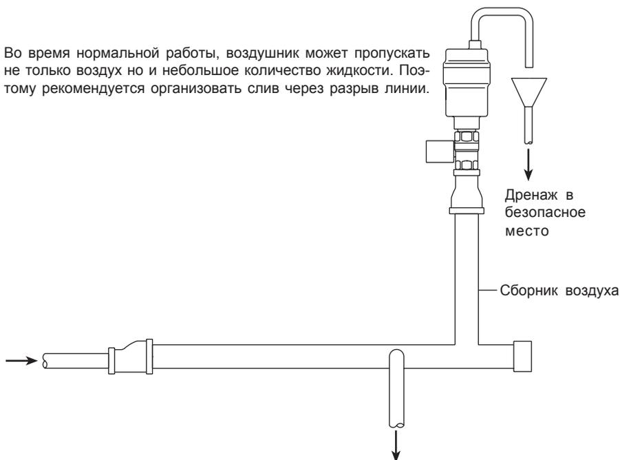
Рис. 2 Типичная установка
