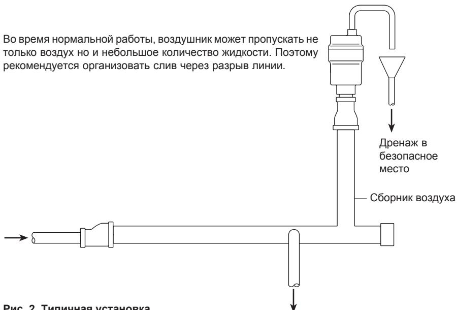
Рис. 2 Типичная установка
