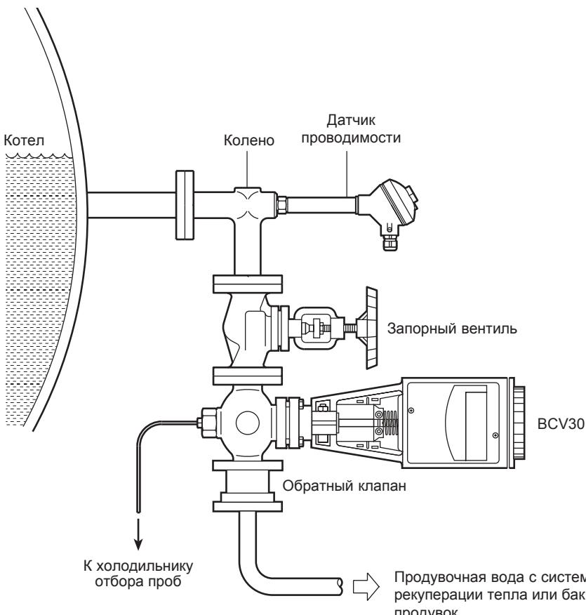
Рис. 2 Схема монтажа с коленом
