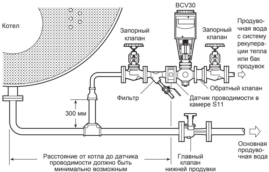
Рис. 4 Монтаж на котле без бокового присоединения
