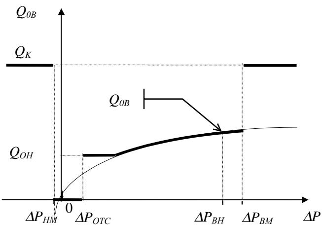
Рисунок 2.7 Вычисление объемного расхода по значениям перепада давления
