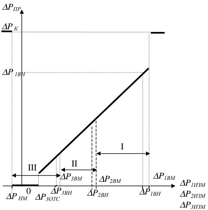
Рисунок 2.6 Преобразование значений перепада давления, измеренных тремя датчиками
