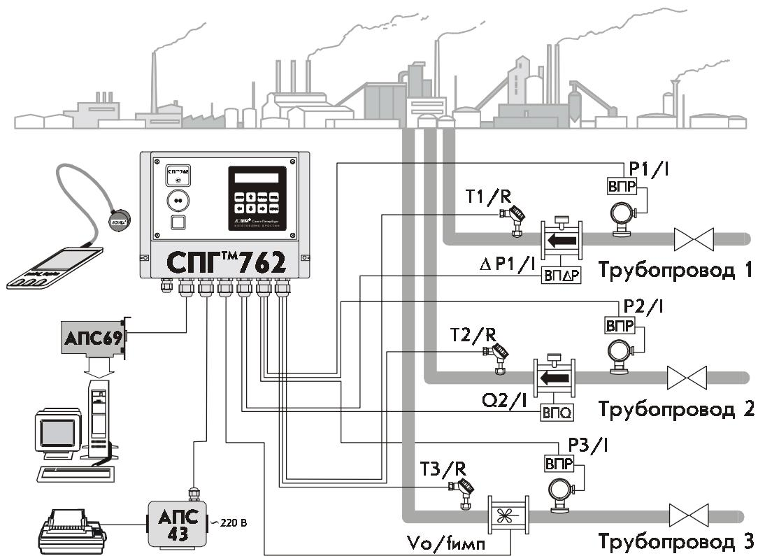
Рисунок 3.4 Пример применения корректора СПГ762 в составе узла учета технически важных газов
