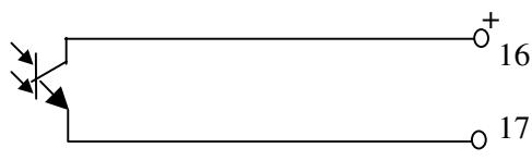
Выход двухпозиционного сигнала
