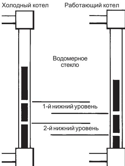
Датчик должен быть установлен в защитную трубу. Она обеспечивает достаточно стабильный уровень жидкости вблизи датчика, исключая воздействие волн извихрений, образующихся на поверхности воды при работе котла. Для каждого датчика должна устанавливаться своя защитная труба.
