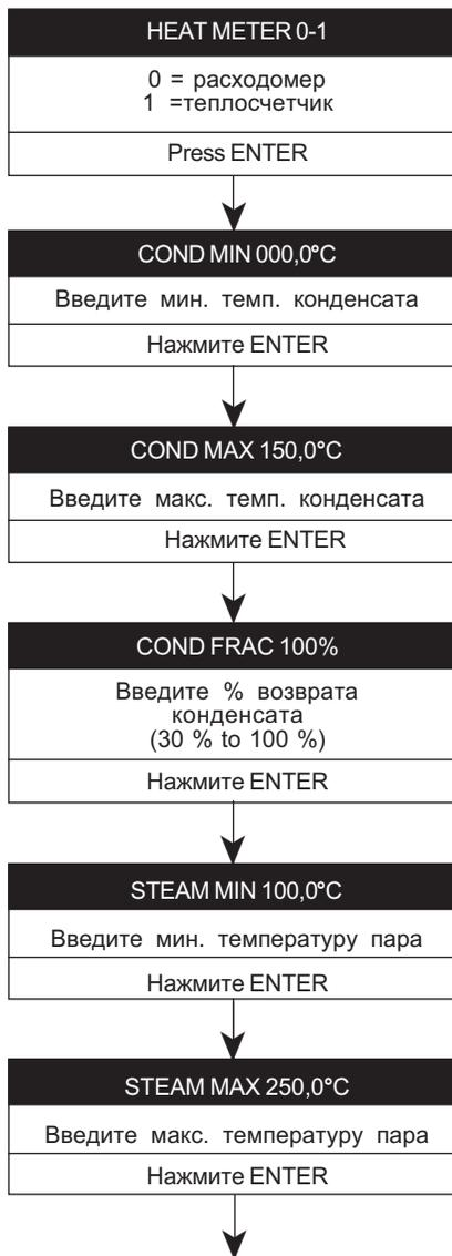
**Прим.:** могут возникнуть ошибки 'STEAM TEMP ERROR' или 'COND TEMP ERROR' если отсутствует давление пара или температура конденсата. См. разд 8.2
