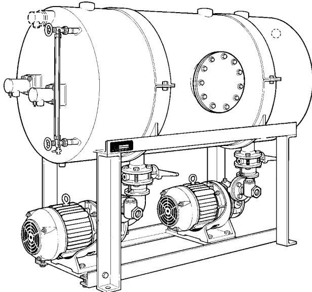
Медные ресиверы крепятся к раме с помощью специальных зажимных обручей. Оба типа оборудованы смотровым люком для проверок, бобышками для присоединения вентиляции, перелива, дренажа и двумя бобышками с резьбой BSP для присоединения конденсатных линий. Оба типа испытываются избыточным давлением 2,1 бар. Дополнительно на ресивер могут быть установлены водомерные стекла с латунными кранами для заполнения и дренажа.
