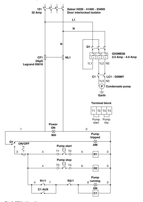
Fig. 2 SPM wiring diagram
