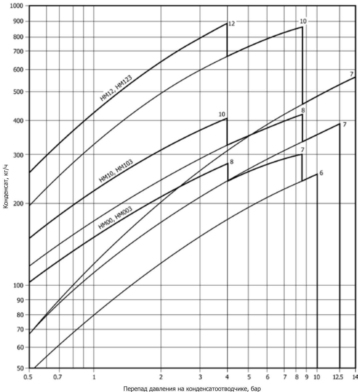
Конденсатооводчик должен быть выбран, основываясь на перепаде давления на конденсатооводчике, а не на расходе конденсата.
