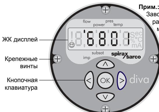
Рис.15 Монитор расходомера DIVA
