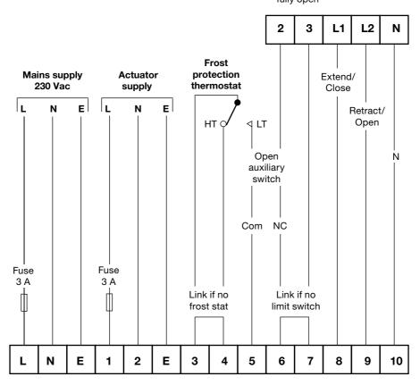
Fig. 2 Wiring diagram
