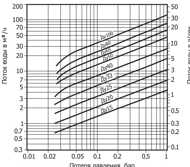
Диаграмма потерь давления при открытом клапане и температуре 20°C. Показанные значения относятся к клапанам с пружиной с горизонтальным потоком. При вертикальном потоке эти значения незначительно отличаются только при частичном открытии клапана.
