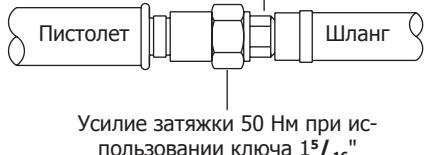
Усилие затяжки 50 Нм при использовании ключа 15/16"
