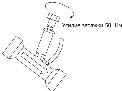
**6.** Вытащите хвостовик быстросъемного соединения из шланга, предварительно отрезав шланг, как показано на рисунке.
